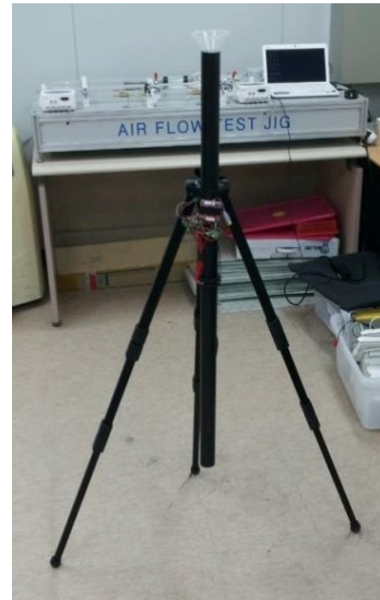
그림 8. 중력을 이용한 먼지 검출 장치 테스트베드 Fig 8. Testbed for dust detection sensor using gravity
