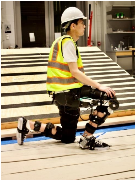
Fig. 1. Knee exoskeleton (US PI)
